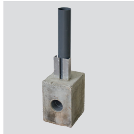
Betonfundament zum Einbetonieren mit Ablauf Betonstein: 295 x 205 x 220 mm (HxBxT) Rohraufsatz: 445 mm Rohr: Ø 75 mm
