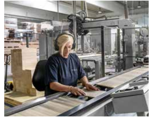
Fertigen der Mittellage aus Gebirgsfichte mit stehenden Jahresringen.
