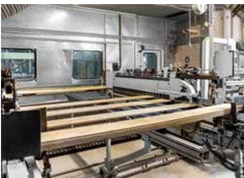
Fräsen von Nut und Feder zur spannungsfreien Verbindung der Holzelemente.
