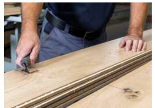
Auskratzen von losen Fasern vor dem Kitten.
