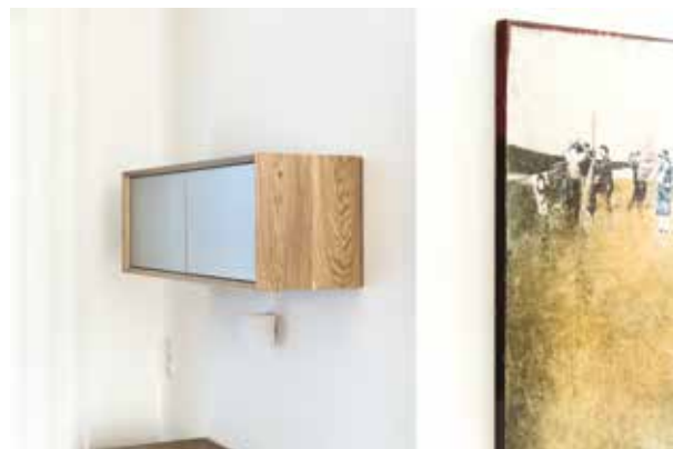
Elegant und schwebend montiert. Der Rahmen dieser Möbel ist innen geschrägt und sauber auf Gehrung gestoßen.
